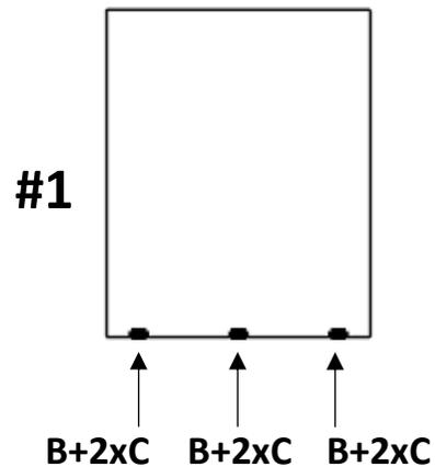
Die Gegenstücke B werden unten bündig an die Mittelseite #1 angeschraubt. Der Abstand zur vorderen und hinteren Kante kann frei gewählt werden.
