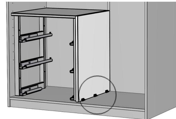
Die kurze Mittelseite wird eingestellt und gegen die Rückwand geschoben. Mit einem Bleistift nun die Positionen der Gegenstücke B markieren.
