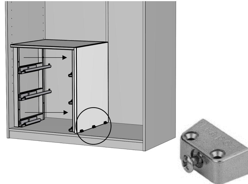
Zum Schluss werden die Teile wieder im Schrank zusammengefügt und mit den Sicherungsschrauben der Trapezverbindern fixiert.
