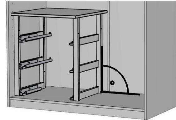
Im Anschluss wird das vorbereitete Schubkastenmodul eingestellt und gegen die Rückwand geschoben. Durch rechtwinkliges Aufstellen der Leiterseiten ergibt sich die benötigte Position der kurzen Mittelseite #1.
