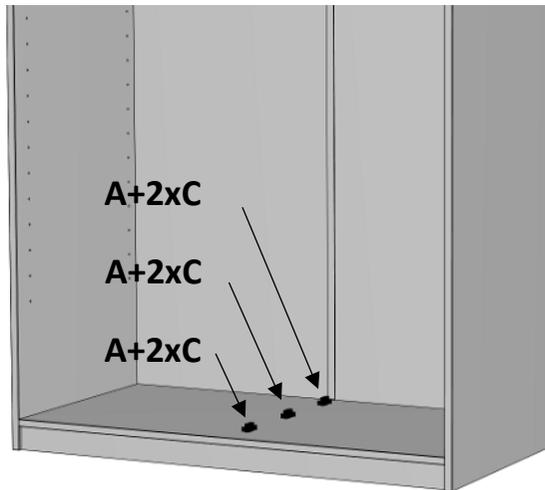
Die Trapezverbinder A werden nun entsprechend der Markierungen am Korpus mit den Schrauben C angebracht.
