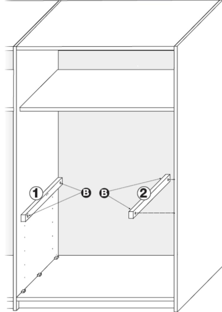
Führungshölzer #1 und #2 jeweils auf die Trägerstifte C aufzusetzen und mit den Holzschrauben B an den Seitenwänden befestigen
