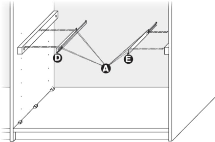
Auszugsschienen D + E jeweils mit 4 Schrauben A an die Führungshölzer montieren
