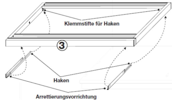
Arretierung lösen. Trägerkasten #3 vorne leicht anheben und die Klemmstifte hinter die Haken einschieben. Vorne wieder absenken und in Bohrung auf der Unterseite einführen. Anschließend Arretierung wieder schließen.
