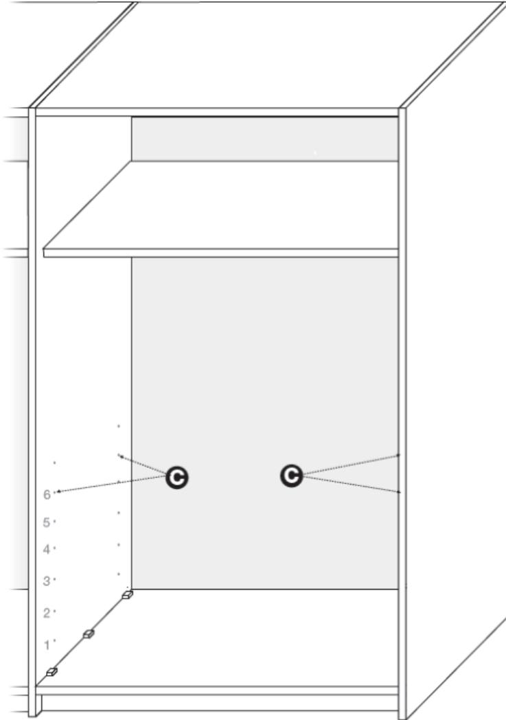
Die Trägerstifte C sind jeweils in die 6. Bohrung von unten in den Seitenwänden einzusetzen.
