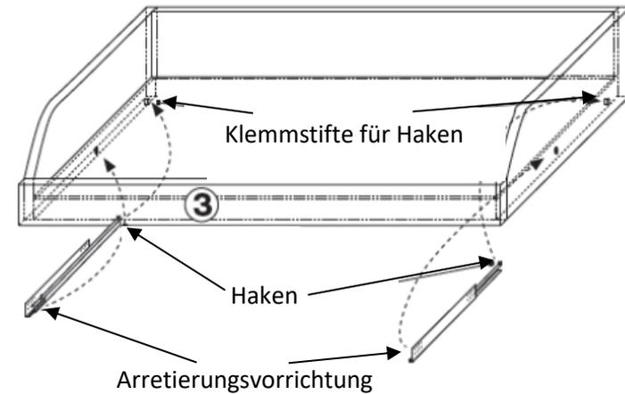
Arretierung lösen. Auszugsfachboden #3 vorne leicht anheben und die Klemmstifte hinter die Haken einschieben. Vorne wieder absenken und in Bohrung auf der Unterseite einführen. Anschließend Arretierung wieder schließen.
