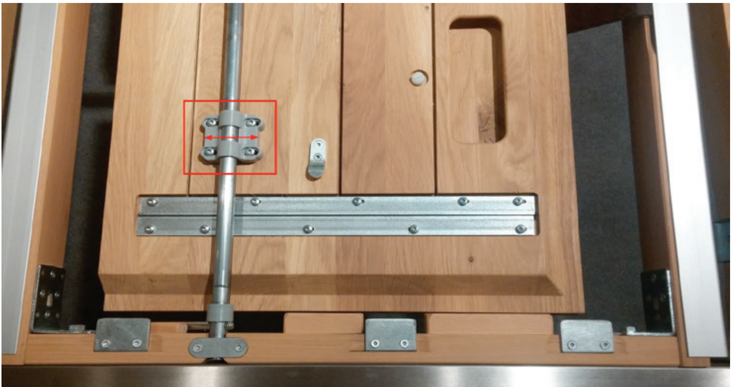
Beispiel 2: Horizontaler Versatz der Klappeinlagen.
