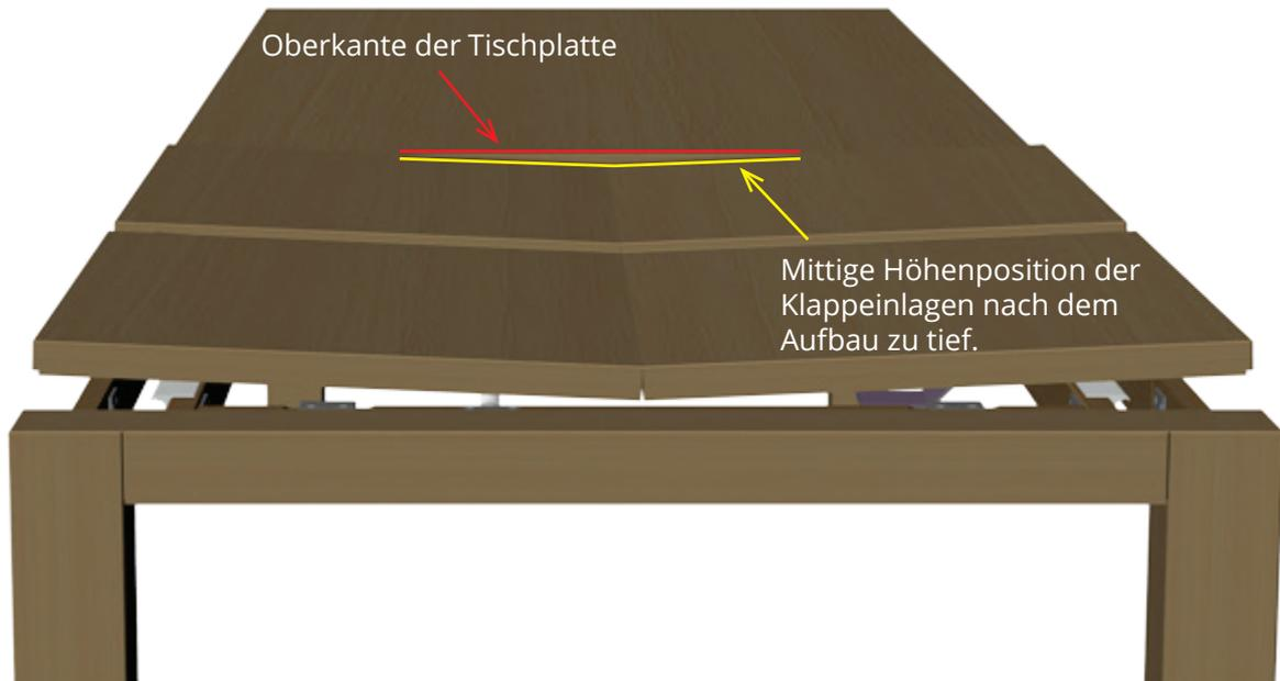
**Beispiel 1:** Die Klappeinlagen der Auszugseinheit haben MITTIG einen vertikalen Höhenversatz zur Tischplatte z. B. 3mm
