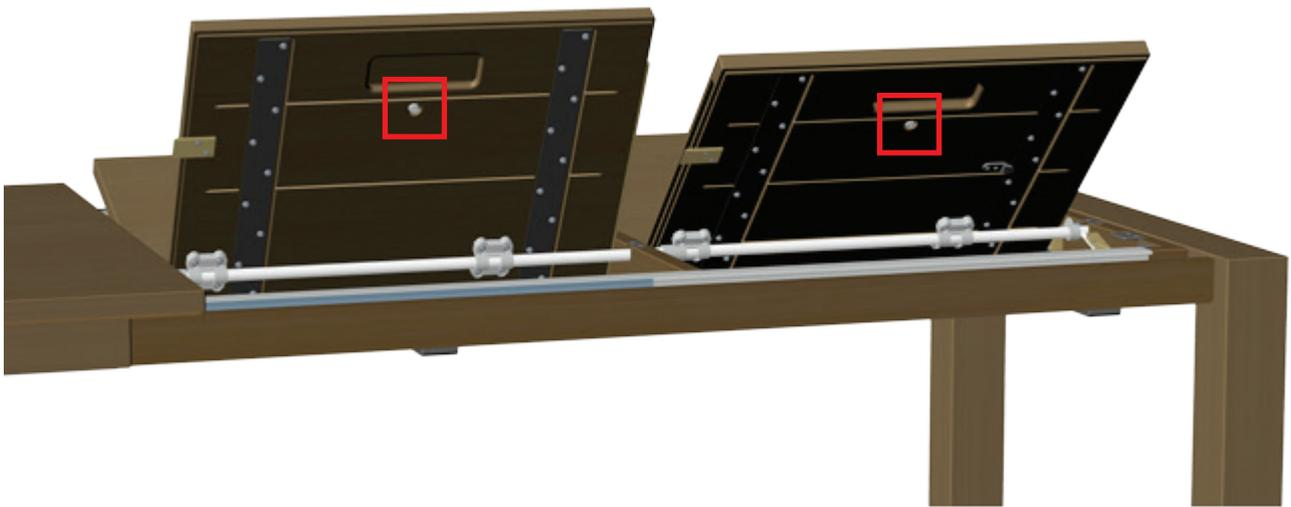
3. Die SEITLICHE Höhenposition der Klappeinlagen kann über die weißen Kunststoffschrauben, welche sich auf der Unterseite der Klappeinlagen befinden, eingestellt werden. Durch das Verstellen dieser Auflagepunkte kann die seitliche Höhenposition der Klappeinlagen verändert werden.
