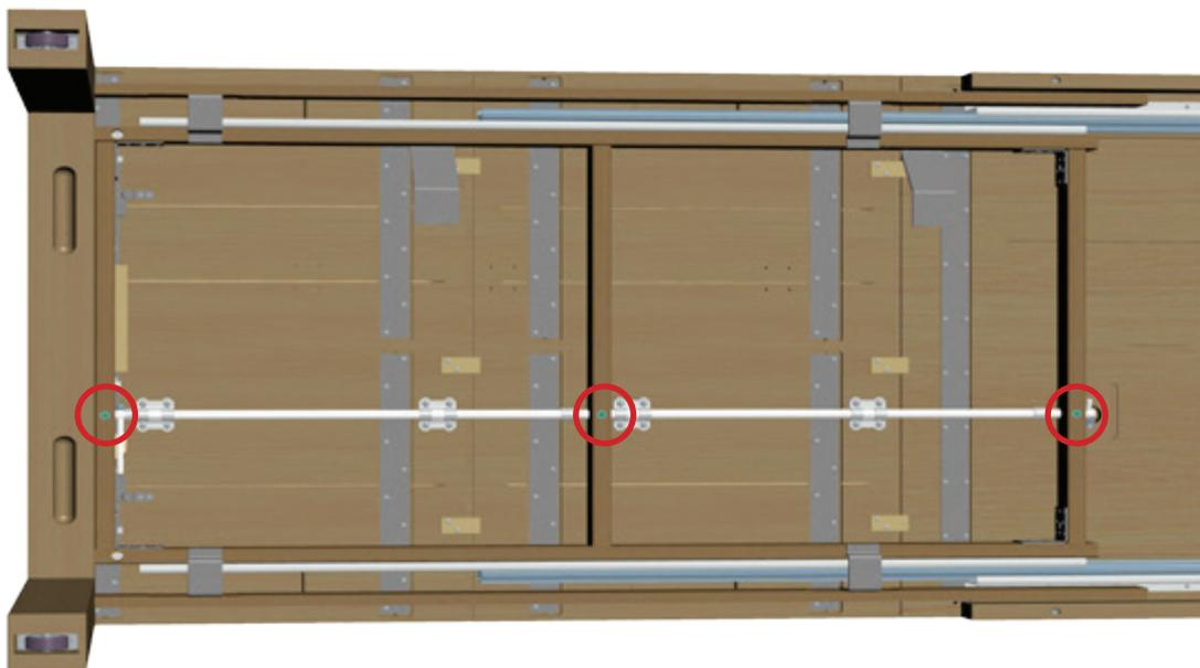
1. Die Höhenposition des Metallrohrs, auf welchem die Klappeinlagen befestigt sind, kann entlang der Querholme mittels der darunter liegenden Inneninbusschrauben verändert werden.
