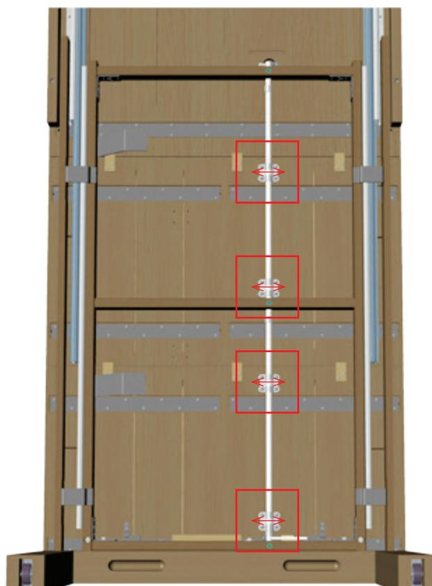
4. Die waagerechte Position der Klappeinlagen kann mittels der Langlöcher in den grauen Befestigungsmanschetten verändert werden. Lösen Sie leicht die Verschraubung an den Manschetten und verschieben Sie danach die Klappeinlagen in die gewünschte Richtung. Klappen Sie die Klappeinlagen auf und überprüfen Sie das Ergebnis. Gegebenfalls wiederholen Sie diesen Schritt erneut, ansonsten schließen Sie die Justierung ab, indem Sie die Schrauben an den Manschetten wieder festziehen.
