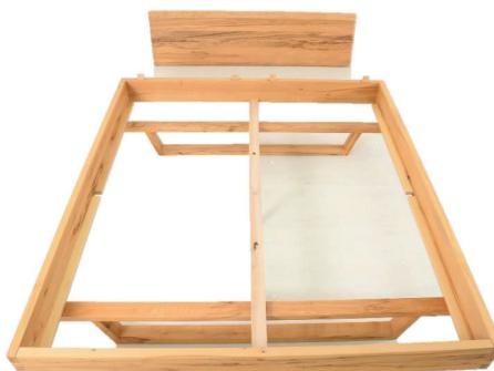
Fußteilstollen ebenfalls vorsichtig in die Fingerzinken stecken. Darauf achten, dass die Mittelunterstützung (ab einer Bettbreite von 140 cm) mittig ausgerichtet wurde und in der Nut eingelassen wird. 1 Blindfuß wird in der Mitte eingesteckt. Falls eine Bettlehne mitbestellt wurde, die Verbindungsplättchen in den Kopfteilstollen stecken (Wahlweise gerade oder leicht geneigte Variante). Nun kann die Lehne aufgesetzt werden.
